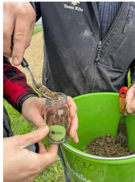
Für die pH-Wert-Messung muss eine Probe abgefüllt werden. Das passende Gefäß ist in der dritten Box enthalten.
