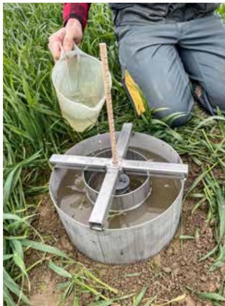
Mithilfe des Infiltrimeters wird die Funktionalität der Bodenstruktur gemessen.
